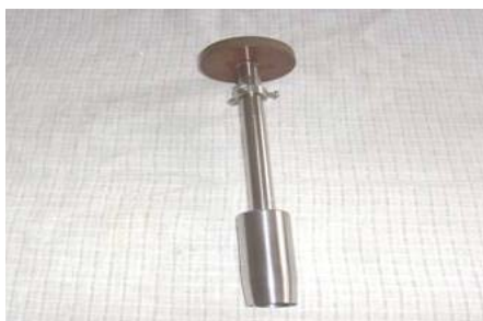
Рисунок 1 – Устройство для изготовления цилиндрических obturаторов
