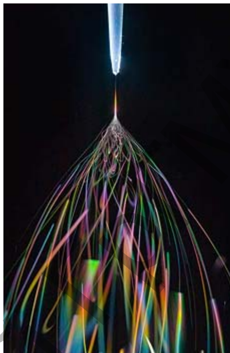
Рисунок 5 – Образование конуса Тэйлора и его дальнейшее расщепление
