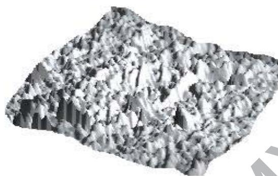
Рисунок 4.3. – Структура поверхностного слоя образца из полиэтилена высокого давления до (а) и после модифицирования с помощью однократного воздействия лазера с энергией импульса 6 Дж (б)
