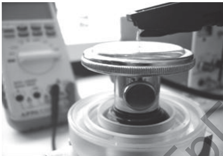
Рисунок 5.4. – Протез, установленный между датчиком пьезозвукоснимателя и мембраной звуковоспроизводящего устройства
