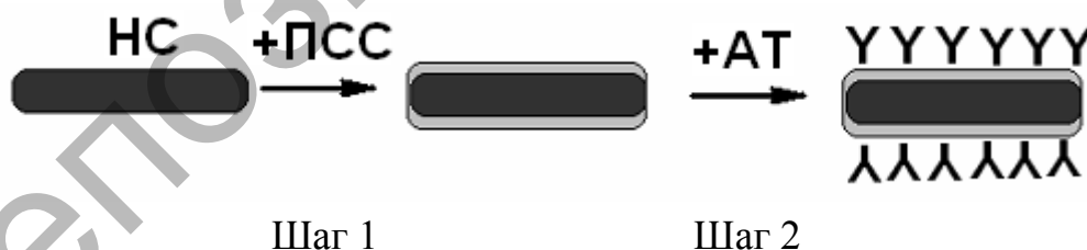
Рис.1. Схема получения конъюгатов наностержней с антителами
