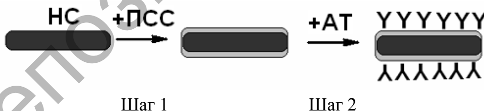
Рис.1. Схема получения конъюгатов наностержней с антителами
